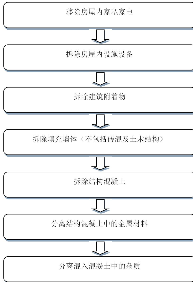
图 5.1.4 房屋拆除流程
