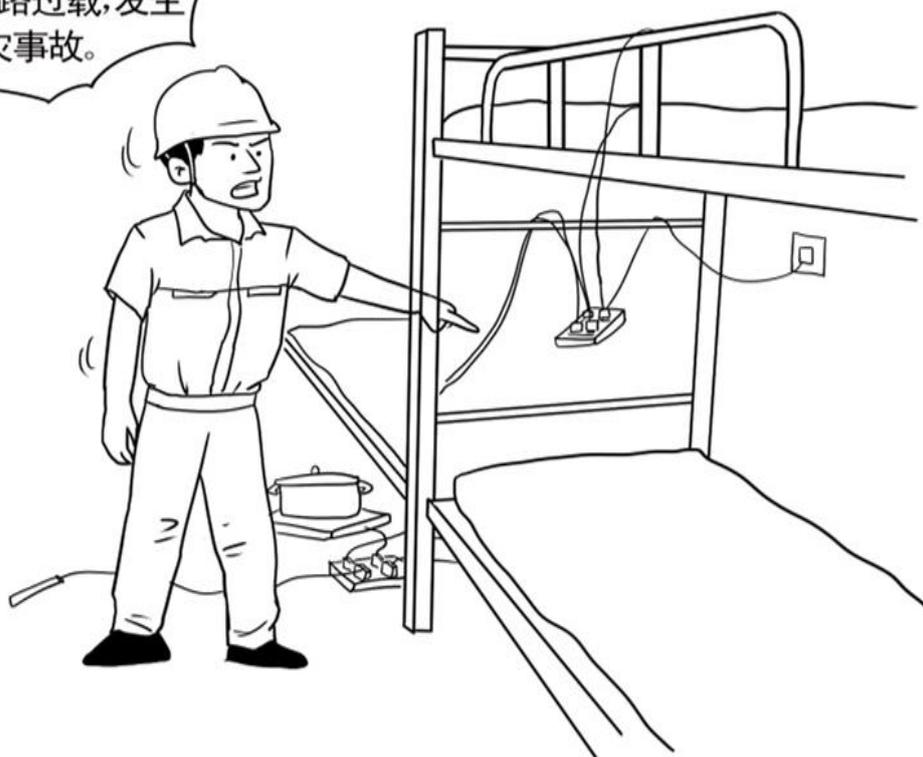
工人宿舍须安装限流器,禁止使用大功率电器,不得私拉乱接电源。宜集中安装电扇,有条件的项目可提供专用用电线路安装空调。
