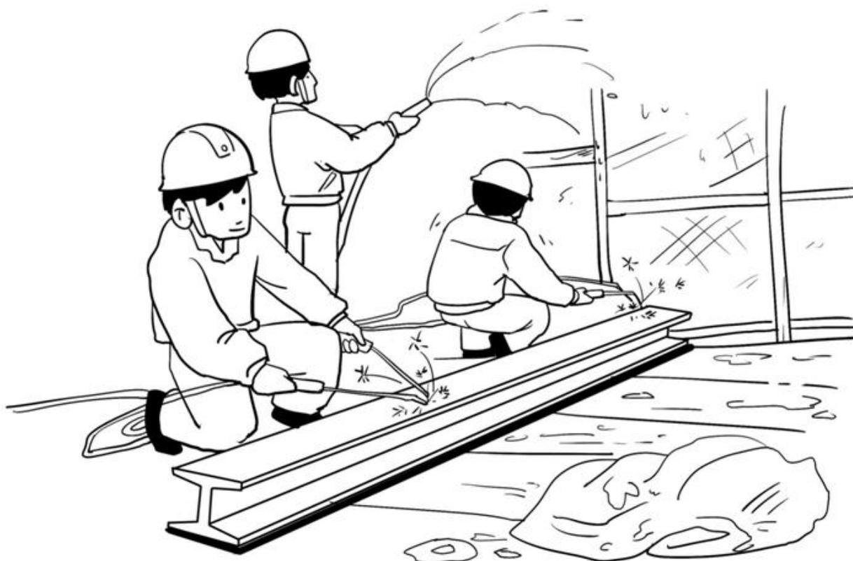
现场进行焊割作业前应对焊割作业区域内的易燃材料进行清理，不能清理的应及时浇水湿润，防止焊割火星及焊渣引燃周边材料。
