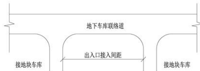
图 5.8.1 地下车库联络道出入口接入间距
