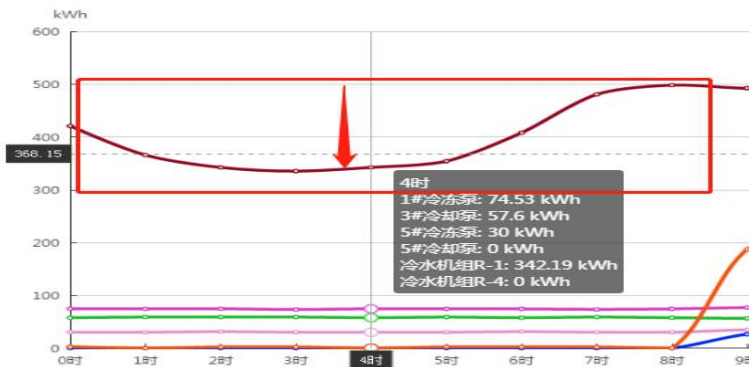
图 4-14 某建筑空调水系统逐时监测用电情况（单位：kWh）
