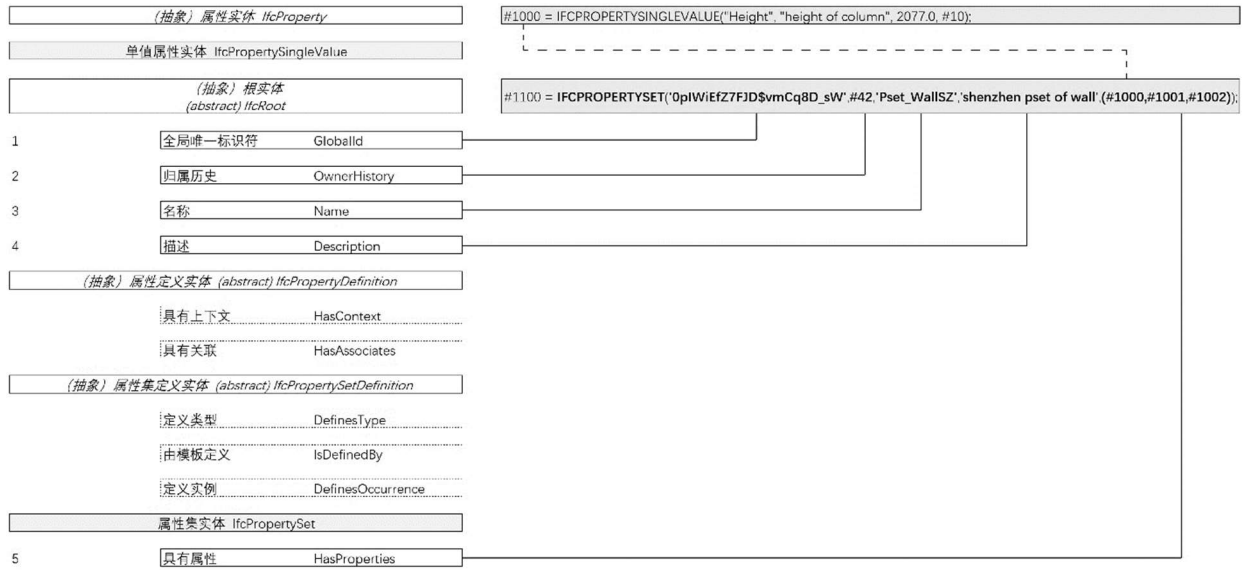
图 8.2.2 属性集实体存储方式
