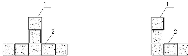
图 5.3.1-2 方钢管混凝土组合异形柱
