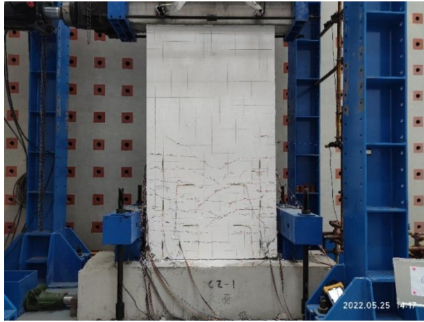
图11 墙模侧剪力墙试件破坏图
