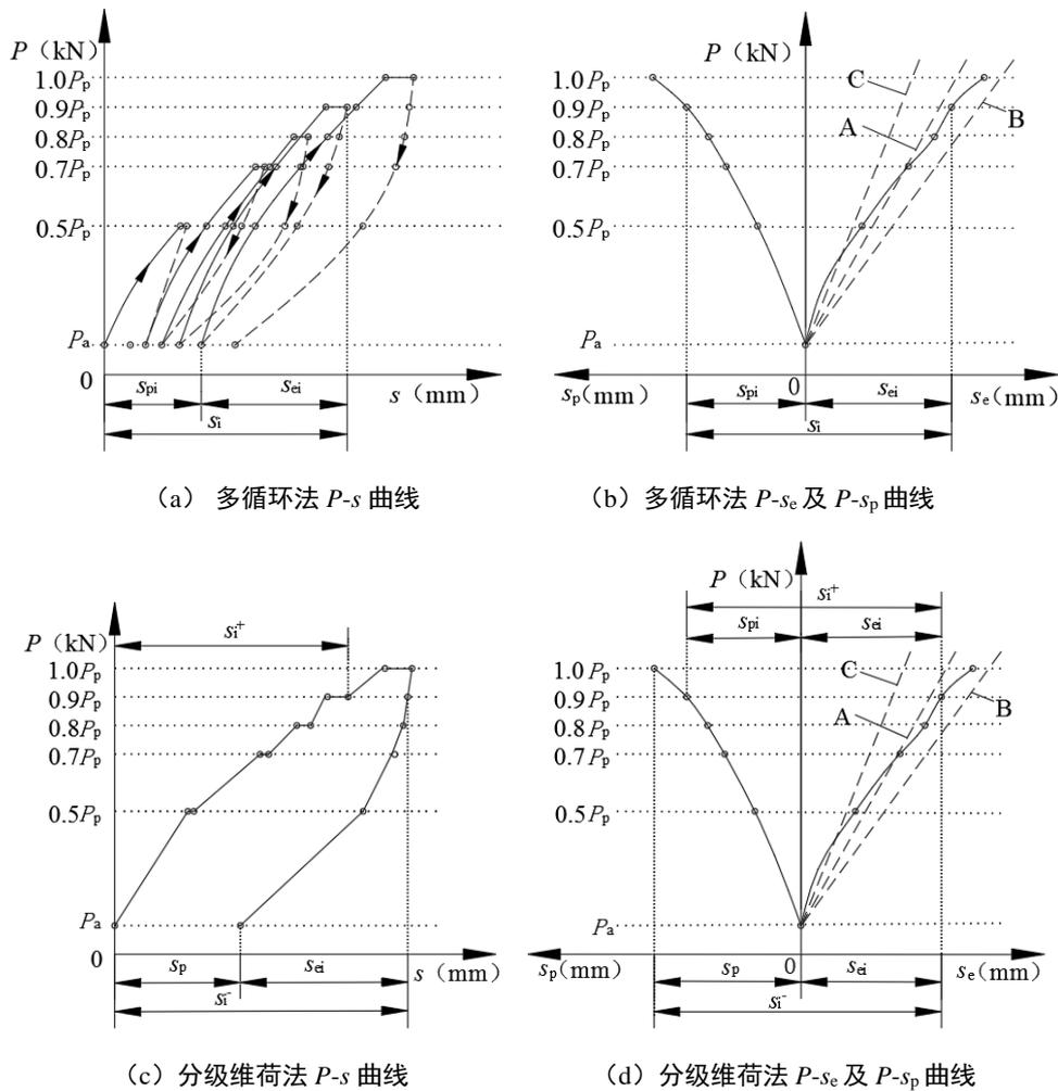
图 4.5.4 荷载—位移曲线示意图
