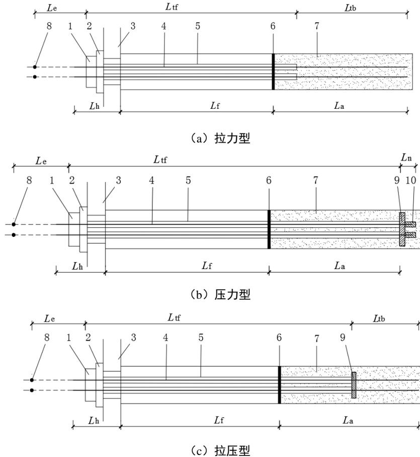
图 1 典型注浆粘结预应力锚杆结构简图
