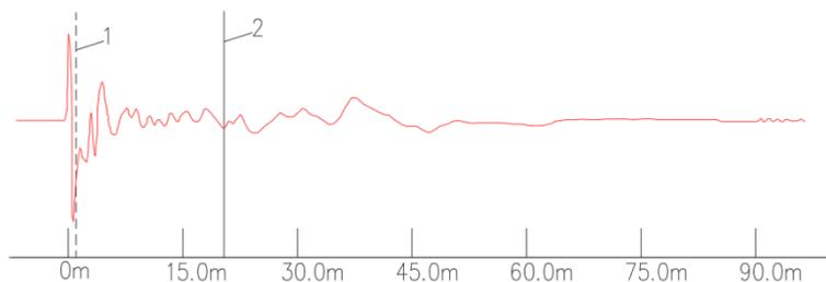
(b) 信号紊乱，无明显反射波形
