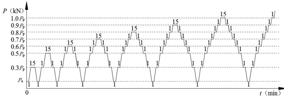
**图 I. 0. 1 极限试验加卸载程序示意图**
