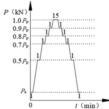
图 B.0.2 快速法加卸载程序示意图
