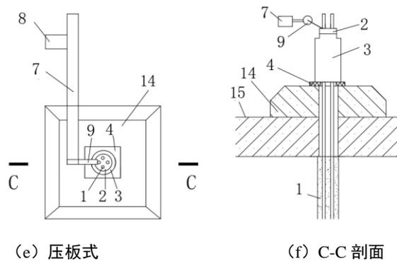
图3 锚杆荷载试验各种反力装置示意图
