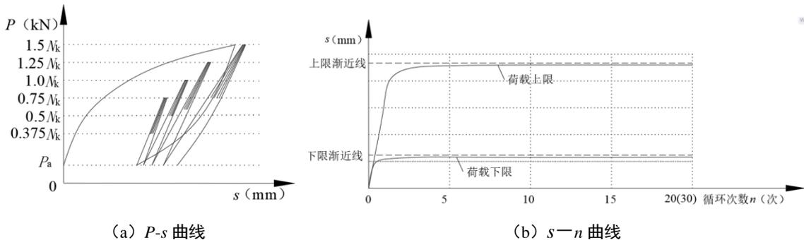
图 L.0.7 疲劳试验曲线示意图
