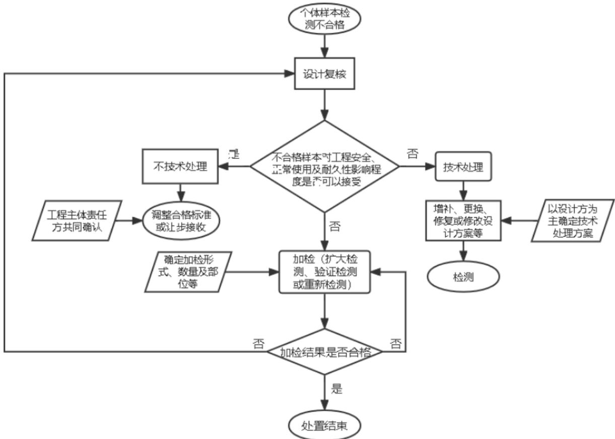
图 H 检测不合格处置流程
