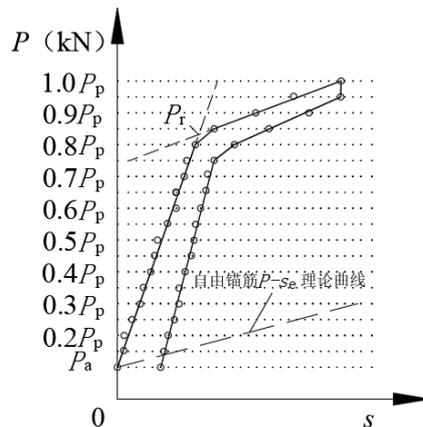
图 4.7.6 持有荷载试验  $P-s$  曲线示意图
