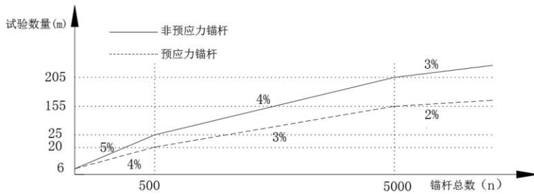
图2 锚固类锚杆验收试验数量
