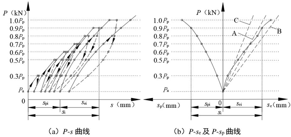
图 I.0.5-1 荷载-位移曲线示意图
