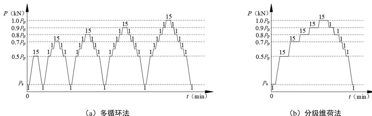
图 4.5.1 适应试验加卸载程序示意图
