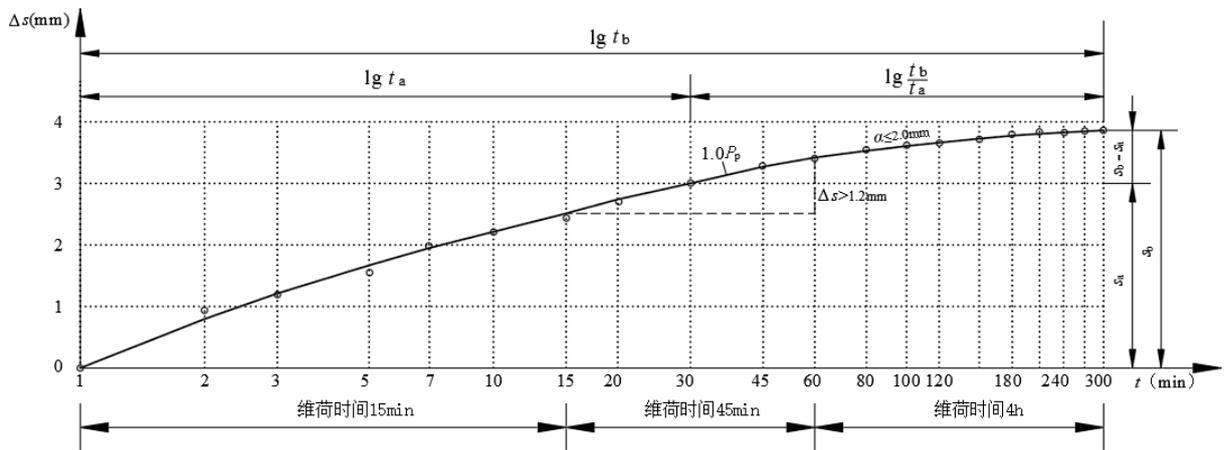
图 I.0.5-3  $s-lgt$  曲线示意图 (维荷时长大于 60min)
