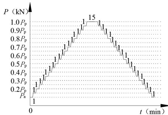
图 4.7.2 持有荷载试验加卸载程序示意图
