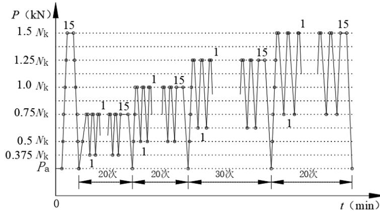
图 L.0.1 疲劳试验加卸载程序示意图
