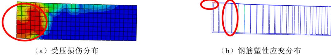
图 19 弯剪型破坏形态对应的框架梁损伤状态
