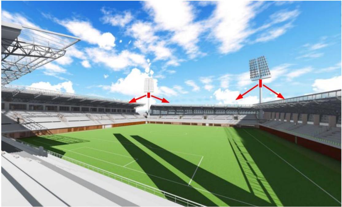
图 7 带照明灯塔的体育场天线布置示意
