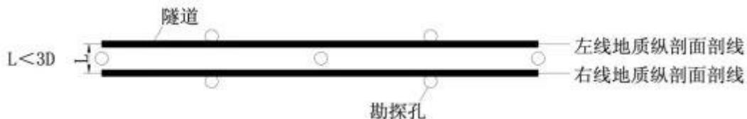
(a) 初勘阶段暗挖区间勘探孔平面布置示意图 (L<3D)
