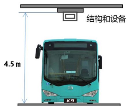
图 4 梁底净高要求示意图
