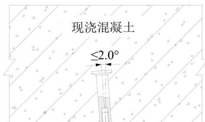
图 7.0.10-2 现浇混凝土套筒预埋倾斜误差要求
