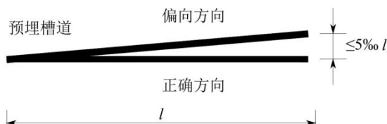
图 6.0.13-2 现浇混凝土槽道预埋轴线偏向误差要求
