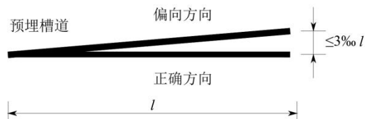
图 6.0.12-2 预制混凝土槽道预埋轴线偏向误差要求
