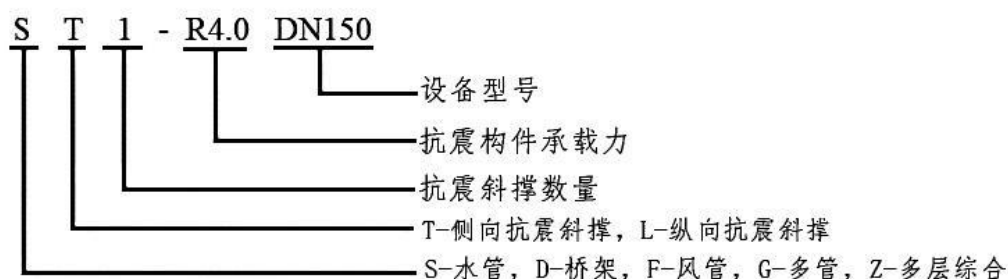
图 4.3.2 抗震支吊架的型号分类方式和标注要求
